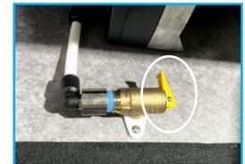
DRAIN VALVE- CLOSED POSITION
